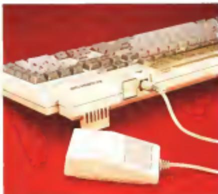
Dettaglio sulla presa per il mouse posta sulla tastiera: il grosso pulsante quadrato è il reset del computer
